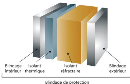
Dans un coffre-fort sans isolant, la température s'élève très rapidement lors d'un incendie. Avec les coffres série MB, vos documents seront mieux protégés. La performance des matériaux ignifuges aux normes DIN 4102 ralentit considérablement la montée de la température interne.
